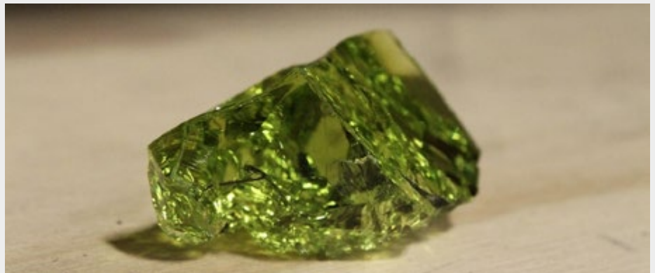
La vitrification des déchets : garantir une stabilité des déchets pour des milliers d'années (GeoMelt®) ©Veolia.
