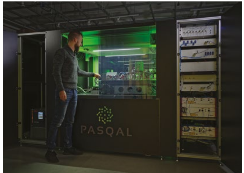
↑ Vue du processeur quantique industriel Fresnel, développé par Pasqal, monté sur une structure standard de rack pour calcul haute performance.
