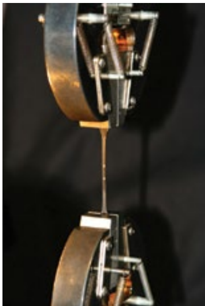
Essai de traction uniaxiale sur un élastomère.
