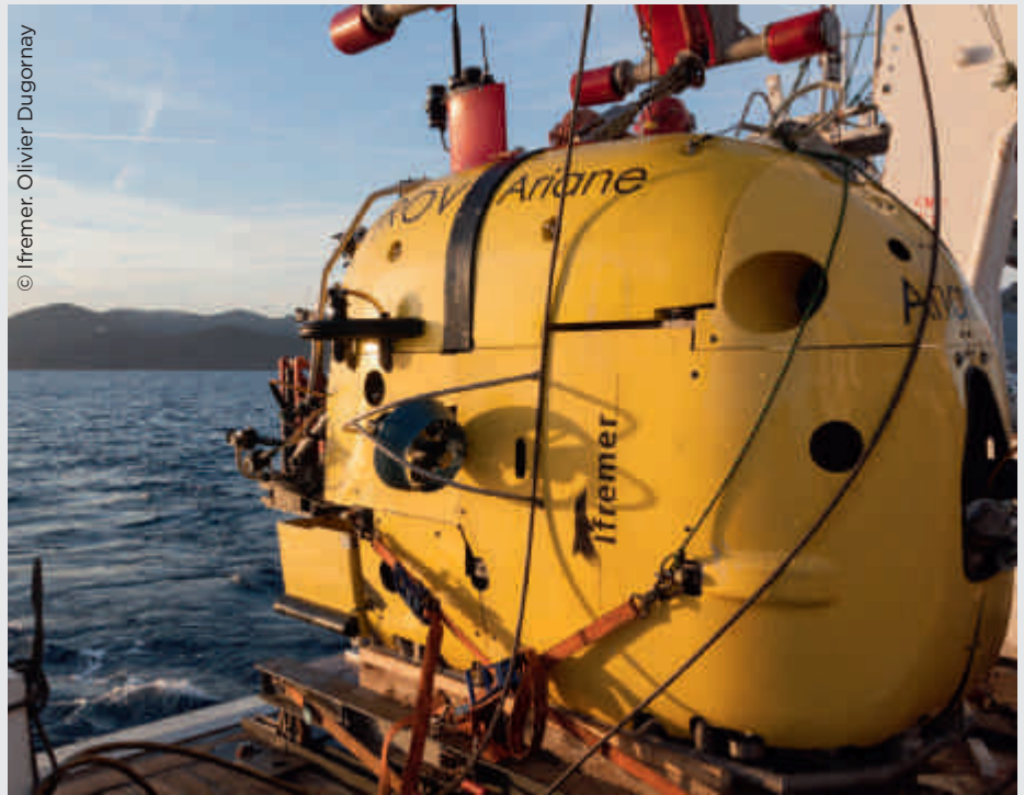
Ariane le sous-marin de nouvelle génération télé-opéré. Il plonge jusqu'à 2 500 m de fond pour des missions de prélèvements, d'inspections ou de cartographie optique et acoustique.
