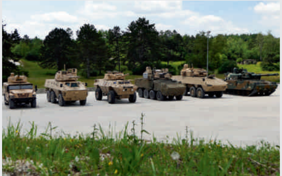
CMI Defence conçoit et fabrique des tourelles équipées de canons de 25 à 120 mm et les commercialise sous la marque Cockerill®. De g. à dr. : la CPWS 25, la LCTS 90MP, la CSE 90LP, la C3030 FSV-AT, la C3030 APC et la C3105 AG.
