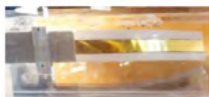
Test d'un drapeau piézoélectrique en soufflerie.
