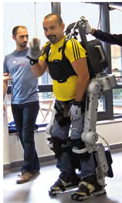
La version V3 de l'exosquelette Atalante est le premier exosquelette autonome capable de fournir une marche quasi humaine.
