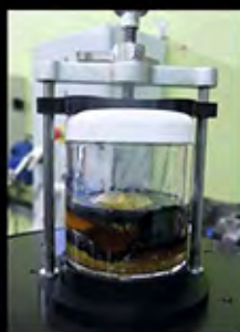
Mise en oeuvre de matériaux du portefeuille technologique ROXEL suivant la technologie ResonantAcoustic® Mixing (RAM)
