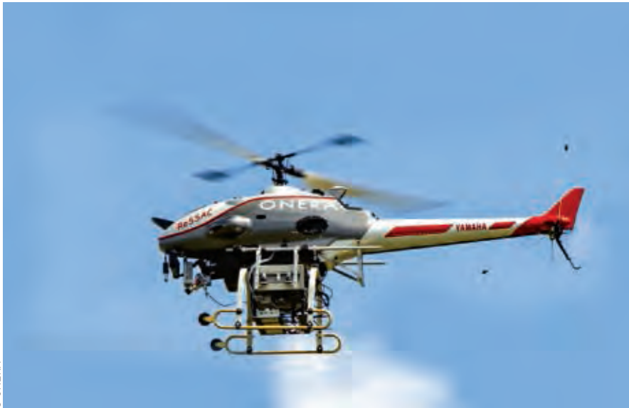
Drone Yamaha Rmax de l'ONERA.
