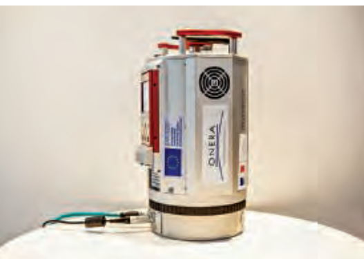
Lidar Riegl capable de reconstruire l'environnement tridimensionnel du drone.
