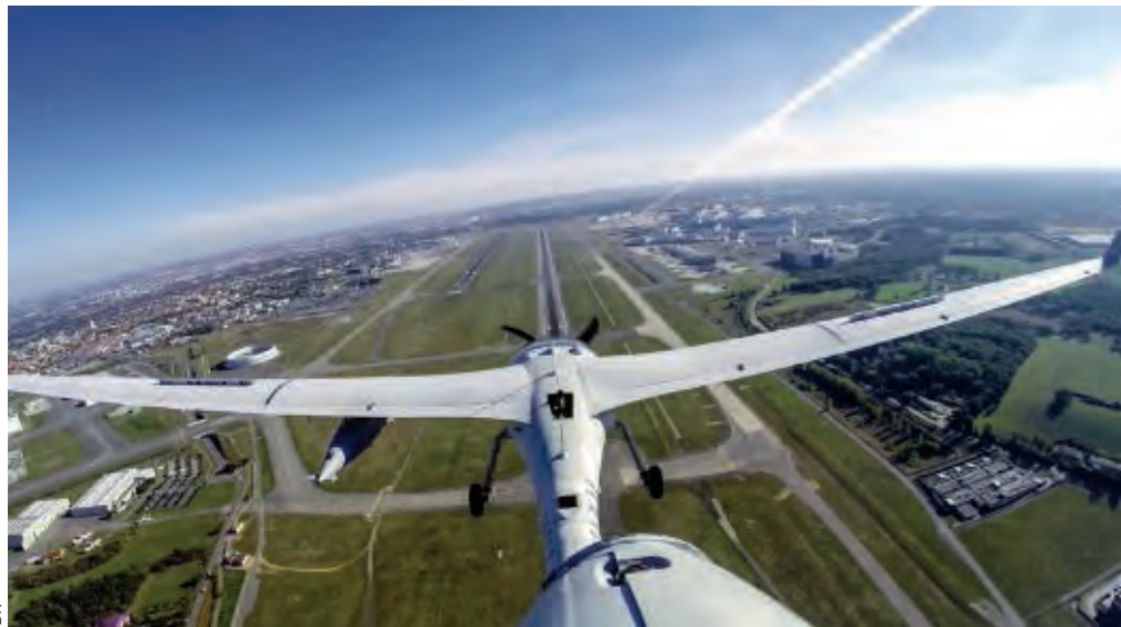
Le Patroller lors d'essais destinés à valider l'intégration d'un drone dans le trafic aéroportuaire de Toulouse-Blagnac et la performance de dispositifs « Voir et Éviter ».
