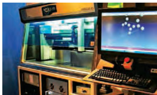
On parle de bioimpression car les briques élémentaires qui sont manipulées et assemblées contiennent de la matière vivante (Bioimprimante Poietis).
