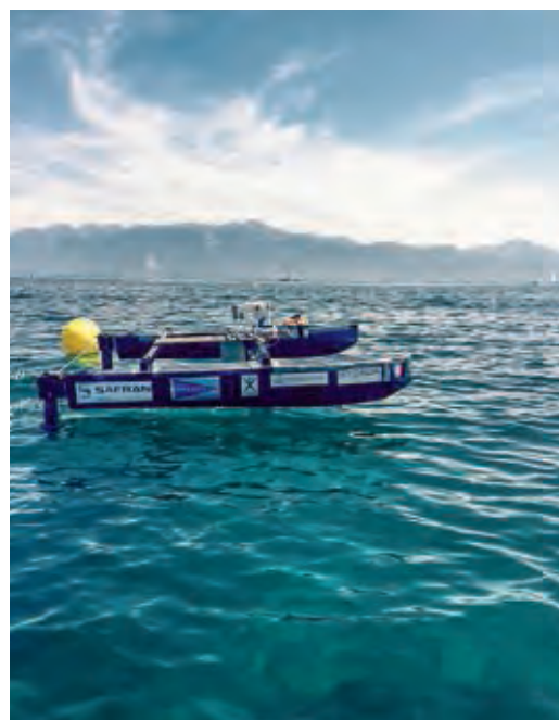
Un bateau « écolo » à base de résine Elium et de fibre de jute.
