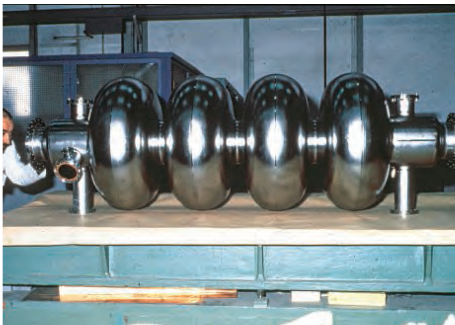
Cavité radiofréquence permettant la réalisation de champs électriques accélérateurs de l'ordre de 50 mV/m.
