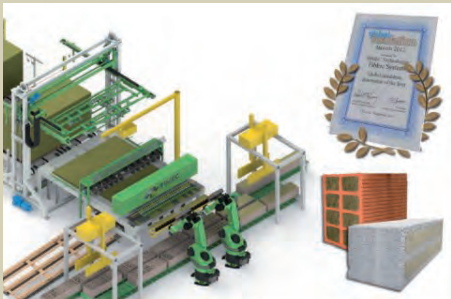
Ligne d'insertion d'isolant robotisée.
