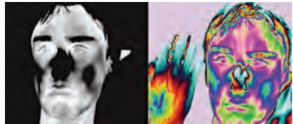
Images obtenues à l'aide d'une caméra infrarouge à base de super-réseaux InAs/GaSb/AlSb refroidie à 80 K.
