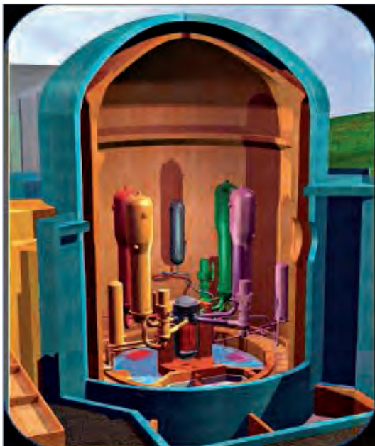
EPR double enceinte de confinement.
