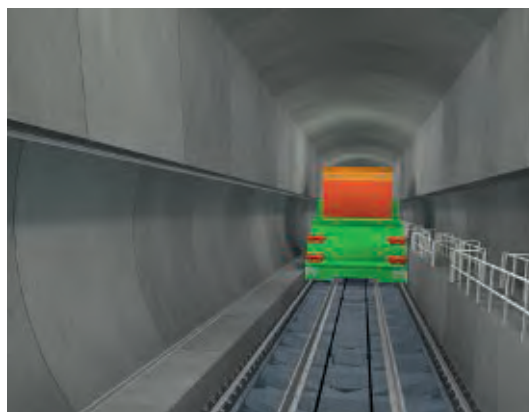
Funiculaire permettant le transfert des colis de déchets vers l'installation souterraine via la descendrière.
