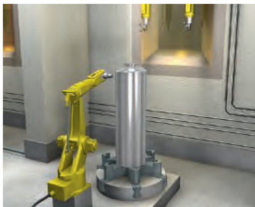
Contrôle d'un colis de déchets de haute activité.
