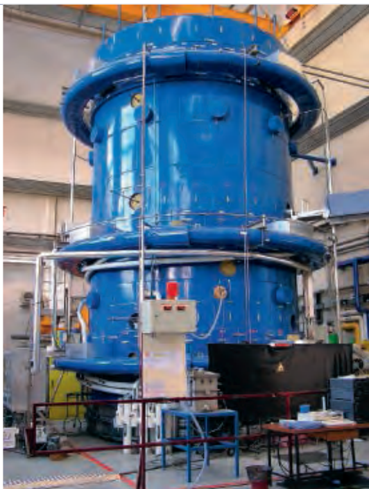
L'installation Mistra à Saclay, dédiée à l'étude du risque hydrogène.
