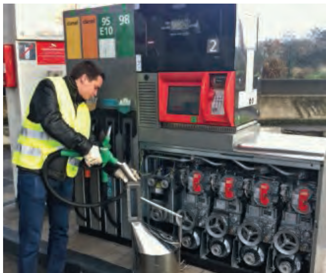
Vérification d'une pompe à essence avec une jauge étalonnée pour s'assurer des quantités délivrées.
