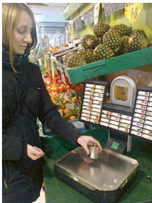
Vérification d'une balance de supermarché à l'aide d'une masse étalon.
