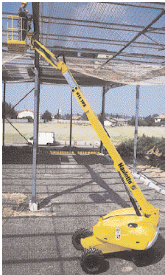
Nacelle télescopique H16 TPX – Diesel 4 x 4. Hauteur de travail : 16 mètres.
