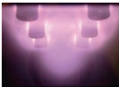
Plasma micro-onde pour dépôt rapide de cellules solaires.
