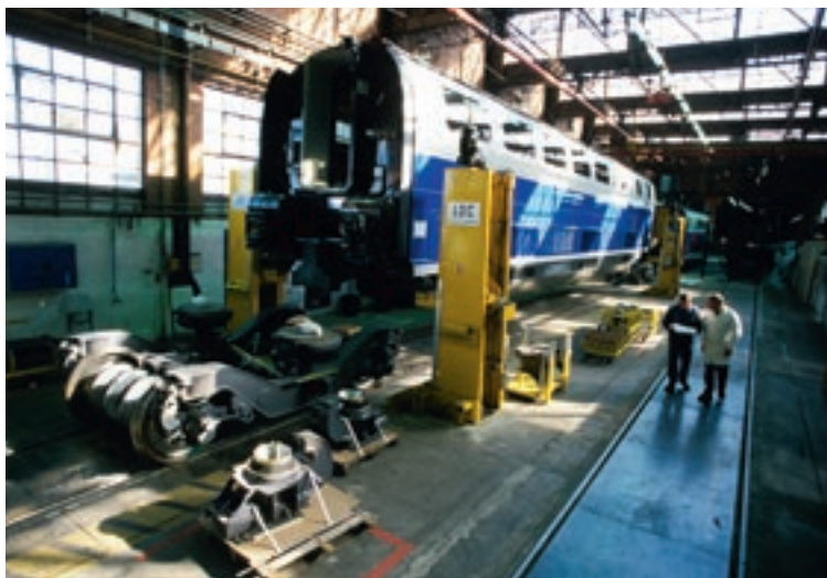
Montage d'une rame de TGV Duplex.
