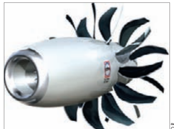
Concept de moteur à hélices rapides contrarotatives non carénées en configuration « pusher » (Open-rotor « pusher »).
