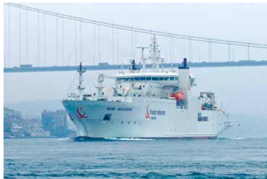
Le navire câblier René Descartes est un navire de pose; il rassemble les toutes dernières technologies recensées en matière de câbliers; 22 000 CV le dotent d'une force de traction supérieure à 100 tonnes. Depuis son lancement en 2002, il a posé 8 000 km de câbles, dont 3 500 ensouillés, aux îles Crozet, en Méditerranée et en mer de Chine.
