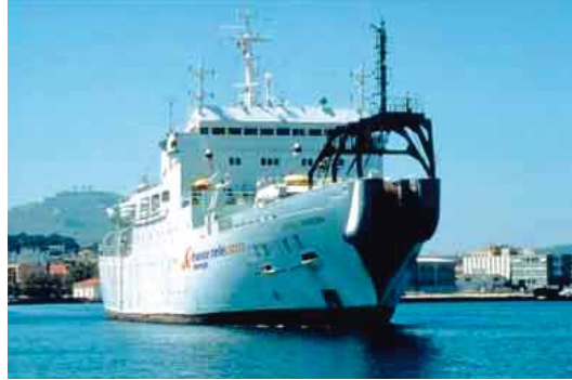
Le navire câblier Léon Thévenin , basé à Brest, est dédié à la maintenance sur l'Atlantique où se trouvent posés 180 000 km de câble. Avec 175 interventions, il est le plus « capé » sur cet océan, plus du quart des réparations.
