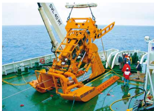
Élodie , construite par SIMEC, filiale de FT Marine, ensouille les câbles jusqu'à 3 mètres et à des sondes pouvant atteindre 2 000 mètres de profondeur.
