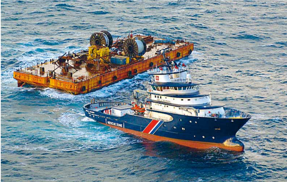
Prise en laisse d'un convoi par le remorqueur Abeille Bourbon .
