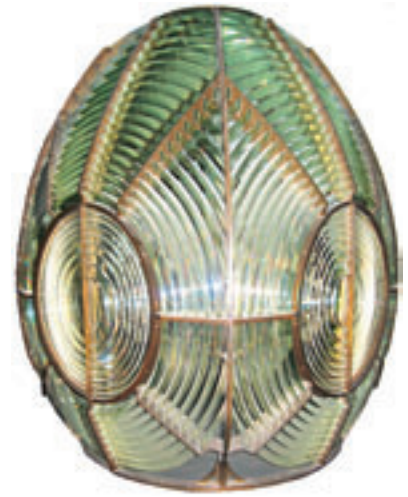
Lentille à échelons (dite lentille de Fresnel), en utilisation dans les phares marins.
