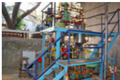
Prototype d'usine rurale de transestérification des huiles végétales pour en faire du biodiésel.
