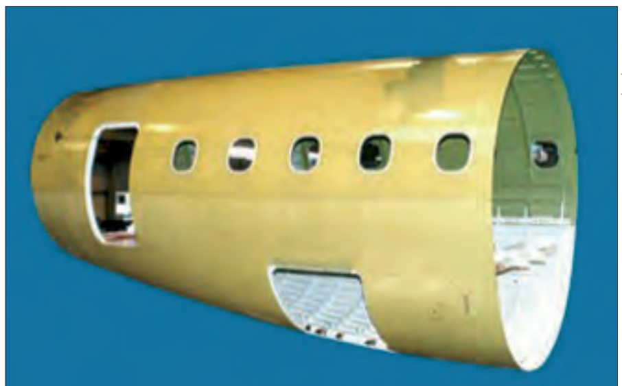
Embraer ERJ 170/190, tronçon de fuselage.
