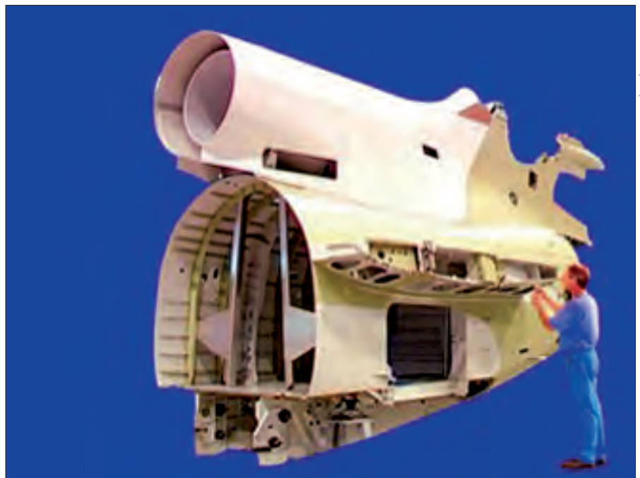
Dassault Falcon 7X, tronçon de fuselage arrière.
