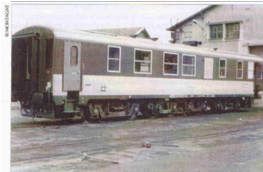
Voiture Mauzin d'auscultation des voies.
